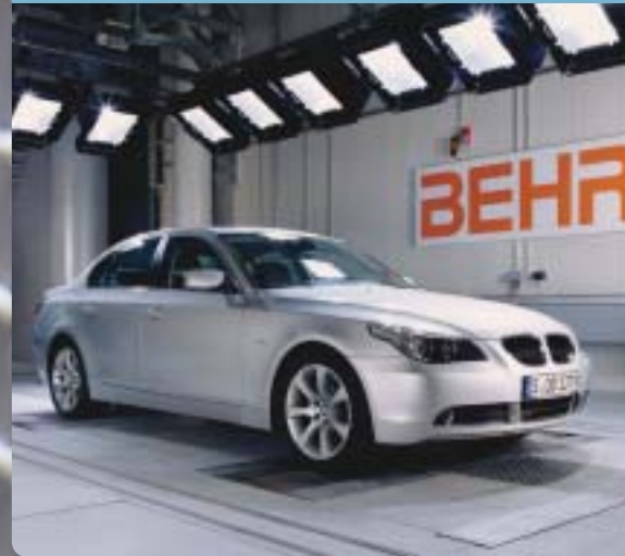
Produkttest im Klimawindkanal.
