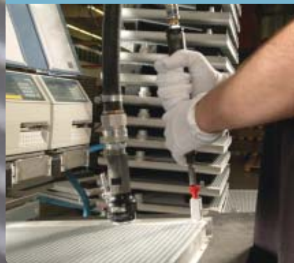
Dichtprüfung am fertigen Produkt.
