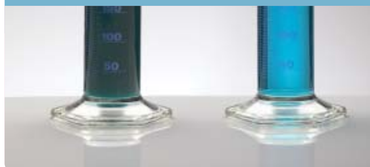
Verbrauchtes (links) und frisches (rechts) Kühlmittel.
